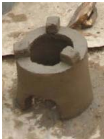
Глиняная энергоэффективная печь
