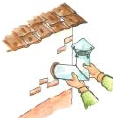
Рис 21. Установка колена в отверстие стены
